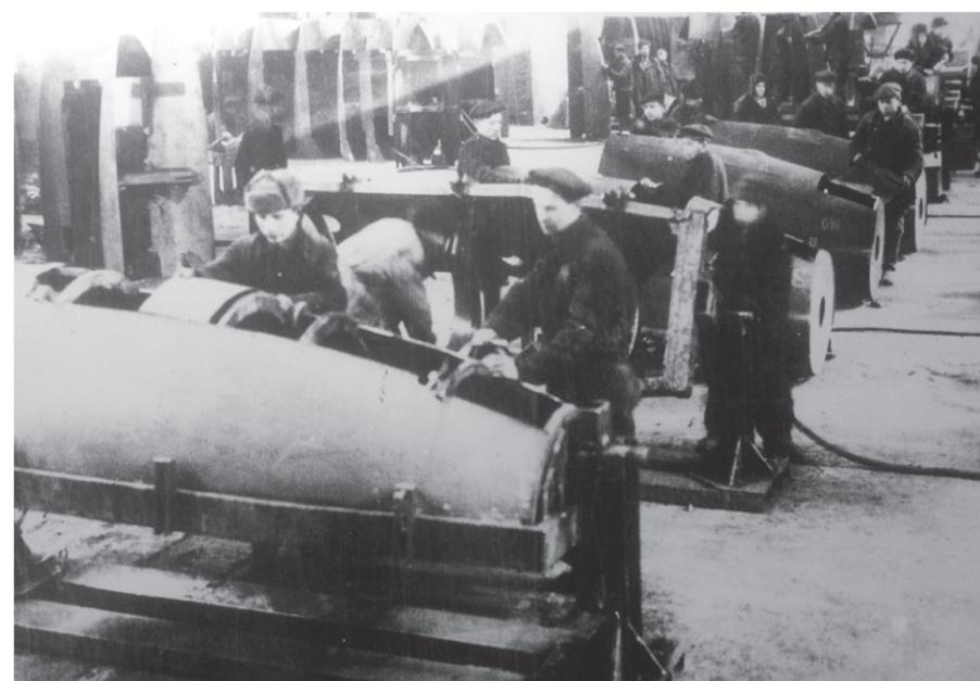
Поточная сборка капота самолета – штурмовика Ил-2
